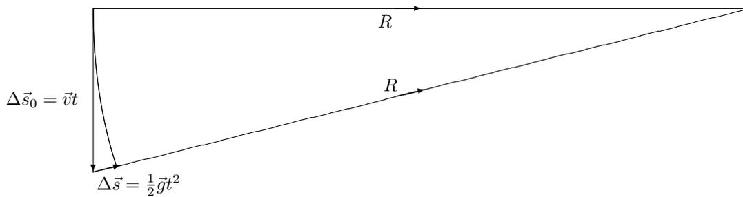
Abbildung 1.5: Eine Zentripetalkraft zieht einen Gegenstand von einer Geraden gerade so ab, dass die Beschleunigung diesen Gegenstand auf einer Kreisbahn hält.
