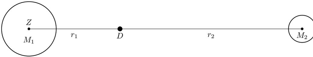
Abbildung 1.1: Zwei Massen  $M_1$  und  $M_2$  drehen sich um einen gemeinsamen Schwerpunkt  $D$ . Die Abstände  $r_1$  und  $r_2$  ergeben sich aus dem Hebelgesetz.  $Z$  ist der Mittelpunkt der einen Masse (Erde). Sowohl beim System Erde-Mond als auch beim System Erde-Sonne liegt der Schwerpunkt innerhalb des massiveren Körpers.
