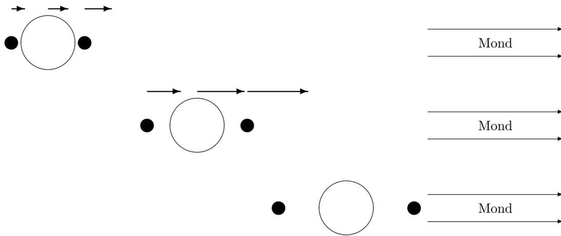
Abbildung 1.4: Die Gezeitenkräfte ziehen einen Gegenstand auseinander, sofern er nicht durch andere Kräfte zusammengehalten wird.
