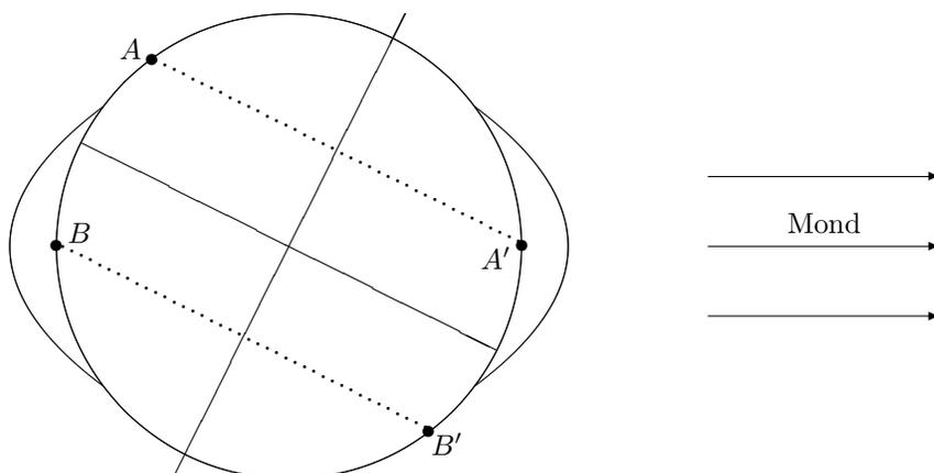
Abbildung 1.6: Durch die Neigung der Erdachse zur Ekliptik ist einer der Flutwulste oberhalb des Äquators, der gegenüberliegende unterhalb. An bestimmten Orten, z.B.  $A$  oder  $B$ , kann es vorkommen, dass nur einer der beiden Flutberge auftritt. Zwischen den jeweiligen Positionen,  $A$  bzw.  $B$  und  $A'$  bzw.  $B'$  liegen etwas über 12 Stunden.
